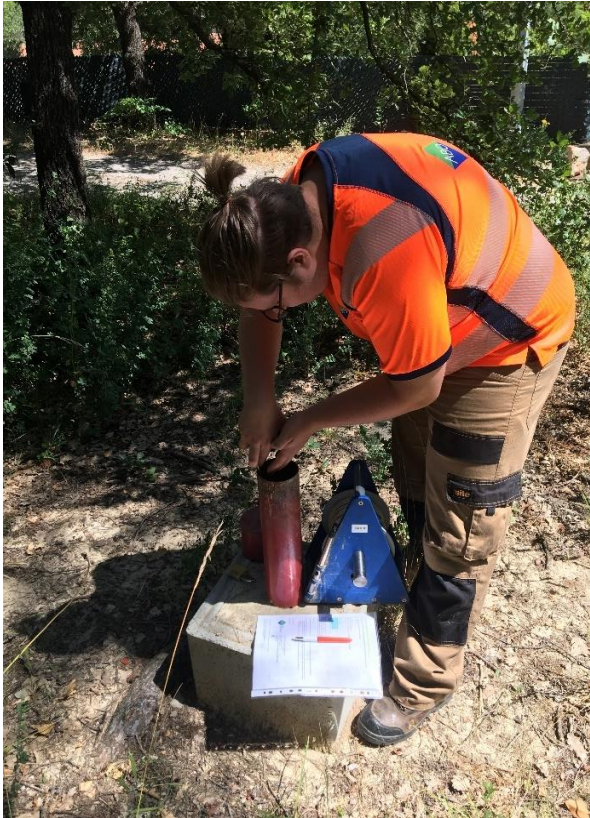
Prise de mesures par l’entreprise ERG pour la commande des sondes piézométriques.
