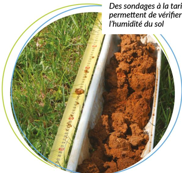
*Des sondages à la tarière\* permettent de vérifier l’humidité du sol*
